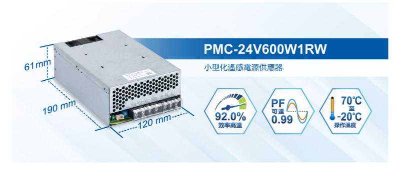
台達 PMC 系列平板型電源新推出 PMC-24V600W1RW/1SW 電源供應器,尺寸縮小 20%。配備 24V 輸出電壓,效率高達 92% @ 230Vac,漏電流降低至 0.75mA 以下且功率因數可高達 0.99。 具備 -20°C 至 70°C 寬範圍操作溫度,高達 50°C 功率降額。此外,新品還配備遙感功能、遙控電源開關、防風扇鎖死過溫度保護以及內置風扇轉速控制等特色功能。電路板具備三防膠塗布可防粉塵及化學物質污染。
