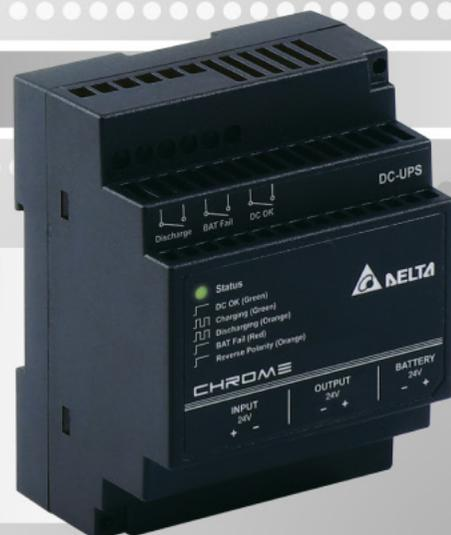
台达新增**直流 UPS 模块** DRU-24V10ACZ 满足安防与工业应用需求。紧凑尺寸节省安装空间，扁平机身仅厚 55.6 mm、高 91 mm。坚固塑料外壳具备阻燃属性，达到 UL 94V-0 认证。直流 UPS 模块由外接电池 24Vdc 达到备用功能，电池容量从 3.3AH 到 12AH，10A 负载下使用 12AH 电池其支持时间可长达 37 分钟 (典型值)。含有继电器干接点提供电池管理信号及 LED 指示灯显示电池状态。高效自然对流冷却设计适用 -20°C 至 +60°C 之大范围运行温度，并通过主要安全认证，包括 IEC/EN/UL 60950-1 ITE 认证及 UL 508 工业认证。
